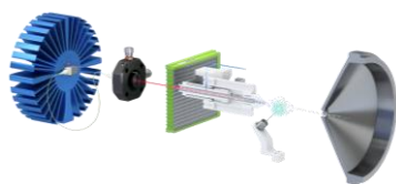
Figura 2 - Esquema da Fonte de Ionização Luxon
