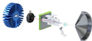
Figura 2 - Esquema da fonte de ionização Luxon
