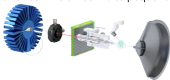
Figura 2 - Esquema da Fonte de Ionização Luxon
